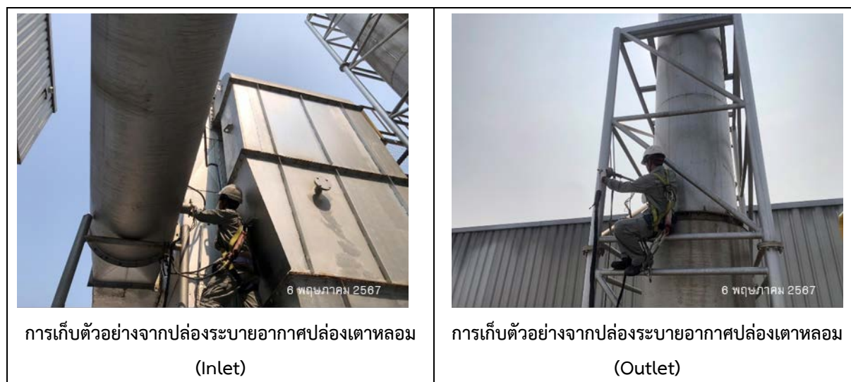
รูปที่ 3.4.1-1 การเก็บตัวอย่างปล่อยระบายอากาศเสียจาก Bag Filter ชุดที่ 1 บริเวณอาคาร Diecast 1 (DC1)
