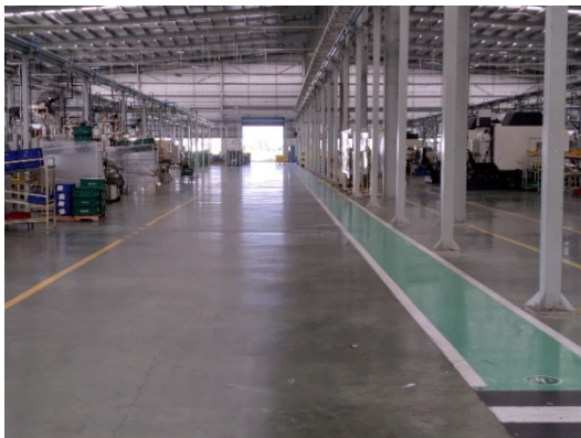
รูปที่ 2-47 เส้นทางการใช้รถฟอร์คลิฟท์แยกจากเส้นทาง เดินของพนักงาน
