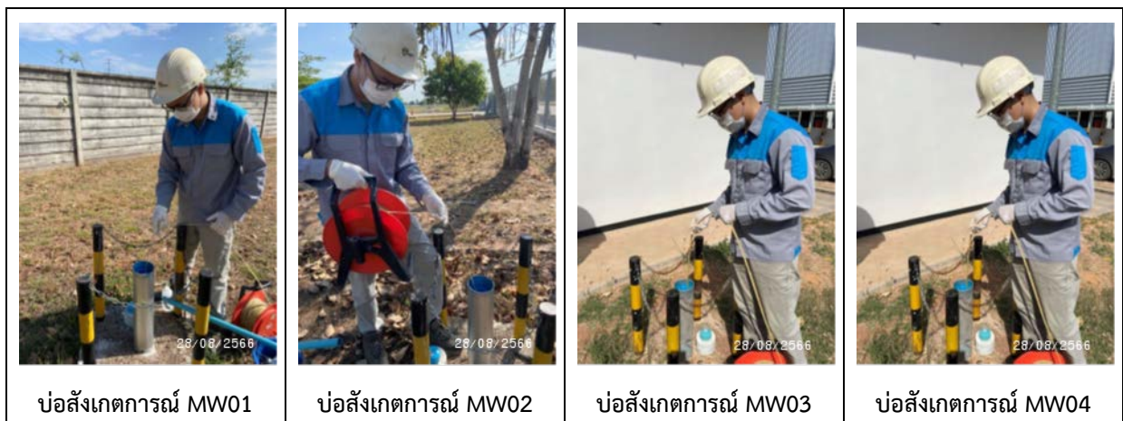
รูปที่ 3.4.4-2 การเก็บตัวอย่างน้ำใต้ดิน
